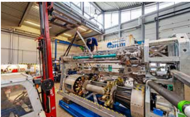
Wartungsarbeiten am MARUM-MeBo70
