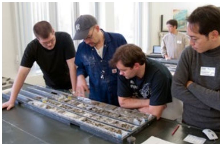
Inspektion eines Kerns des internationalen Bohrprogramms
