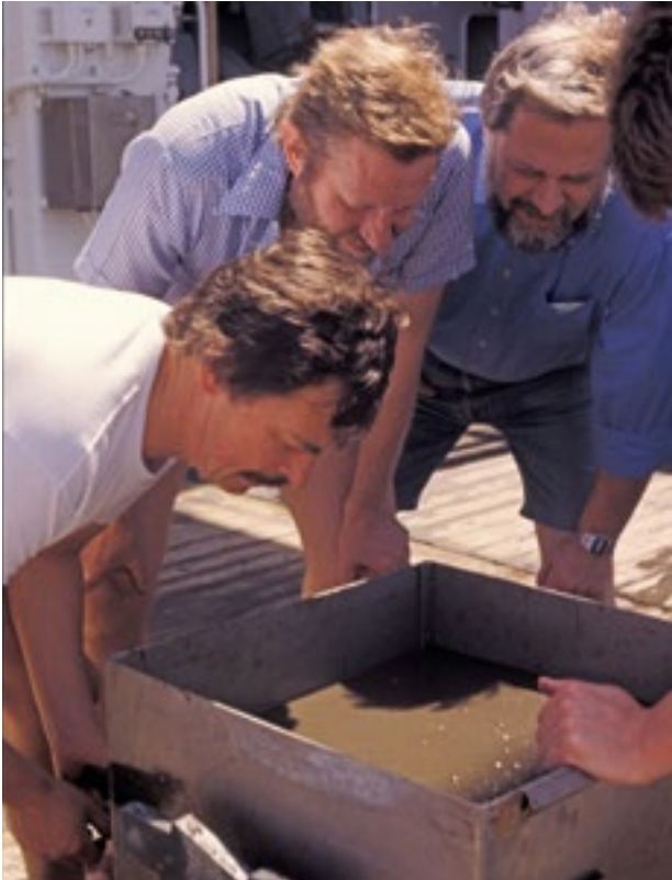
Inspektion der Oberfläche eines Kastengreifers aus 7.622 m Wassertiefe, Romanche-Bruchzone im äquatorialen Atlantik, M9-4
