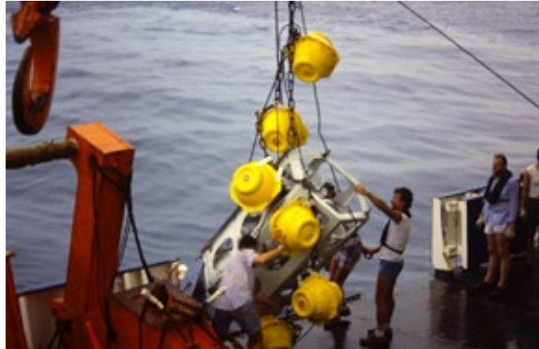
Bergung einer Sedimentfallen-Verankerung auf FS METEOR
